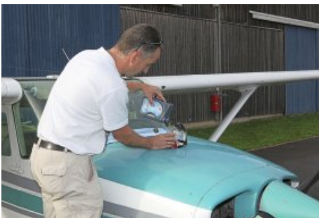
Beim Öleinfüllen ist auf Sauberkeit zu achten, damit kein Schmutz in den Motor gerät. Foto und Copyright: Juhrig
